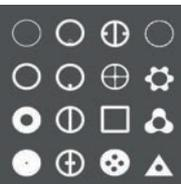
Neben der Standard-Geometrie eines einfachen, runden Querschnitts mit verschiedenen Wandstärken, sind auch Sonder-Geometrien, wie zum Beispiel Flach-, Vierkant- und Dreieckskapillaren, verfügbar. Hier finden Sie einige unterschiedliche Kapillarenprofile, die wir für Sie standardisiert anbieten können. Für unsere Kunden haben wir bereits weitaus mehr Varianten angefertigt – vom einfachen runden Rohr bis hin zur mehrfach gebündelten Multikanalkapillare.
